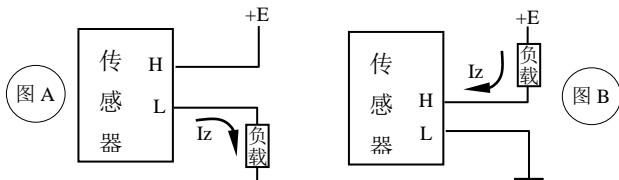
6. 小于  $500mA$  的电流测量可以采用安匝输入方式，此时传感器分辨率提高，量程变窄，其它技术指标不受影响。
