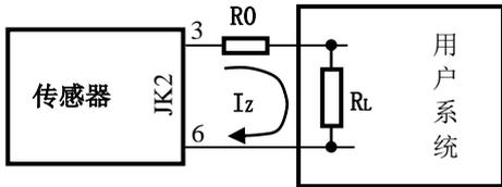
5. 小于 500mA 的电流测量可以采用安匝输入方式, 此时传感器分辨率提高, 量程变窄, 其它技术指标不受影响。
