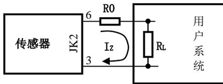
5. 小于 1A 的电流测量可以采用安匝输入方式，此时传感器分辨率提高，量程变窄，其它技术指标不受影响。
