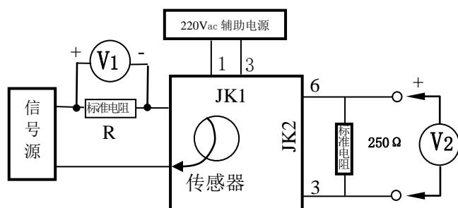
注：图中用标准电阻 R 把被测电流转化为交流电压，用 V1 监测。用  $250\Omega$  标准电阻把电流输出转换为电压输出，用 V2 测量。
