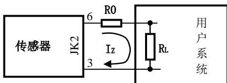
4. 小于  $500mA$  的电流测量可以采用安匝输入方式，此时传感器分辨率提高，量程变窄，其它技术指标不受影响。
