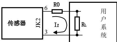
5. 小于  $50mA$  的电流测量可以采用安匝输入方式，此时传感器分辨率提高，量程变窄，其它技术指标不受影响。
