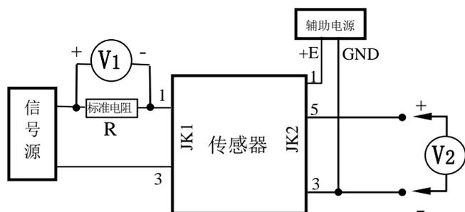
图中，用标准电阻 R 把被测电流转化为交流电压，用 V1 监测。
